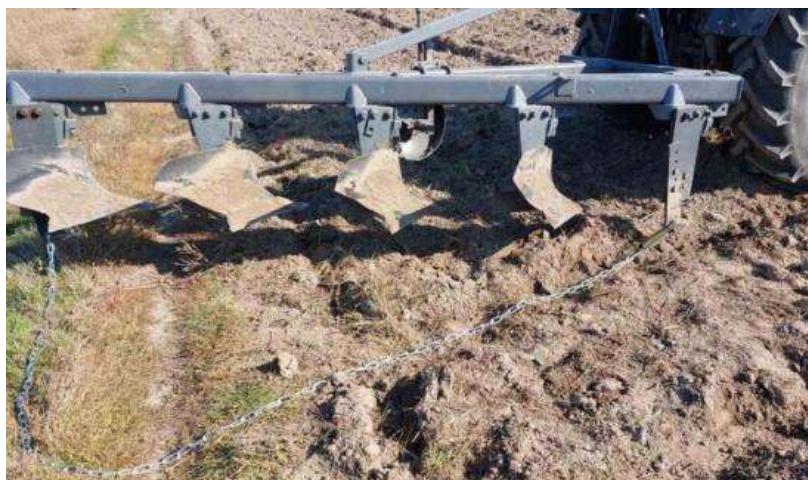
Рис. 1 – Комбінований ґрунтообробний агрегат в складі: плуг ПЛН-5-35 (модернізований) та гнучкий ланцюговий ґрунтопоглиблювач
