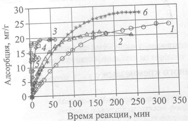
Рис. 1. Гравиметрические данные хемосорбции \text{PCl}_3 на пирогенном кремнеземе: 1—5 — подготовка образцов 3 ч на воздухе при 400^\circ\text{C} и 1,5 ч в вакууме при 650^\circ\text{C} ; температура реакции: 1— 300^\circ\text{C} , 2— 333^\circ\text{C} , 3— 360^\circ\text{C} , 4— 428^\circ\text{C} , 5— 465^\circ\text{C} ; 6 — подготовка образца вакуумированием 2 ч при 200^\circ\text{C} и реакция при 200^\circ\text{C} .
