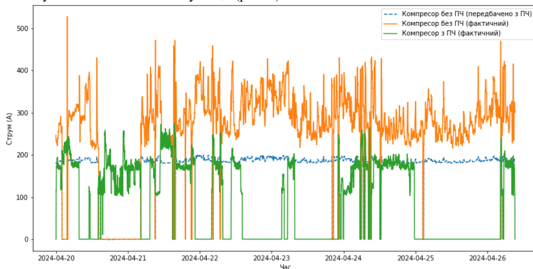
Рис. 5. Результати моделювання роботи компресорної установки без ПЧ, за умови її оснащення ПЧ
