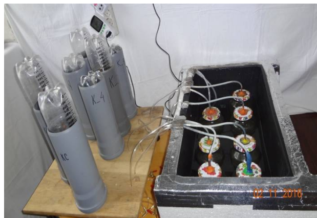
Рис. 2. Схема та фото експериментальної установки: 1 – термостат; 2 – реактори; 3 – евідіометри; 4 – датчики тиску; 5 – газоаналізатор; А – субстрат; В – біогаз; С – розчин кухонної солі.
