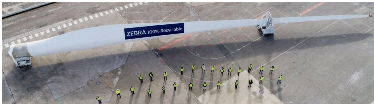
Рис. 2. Фото прототипу лопаті, яка підлягає вторинній переробці на 100 %
