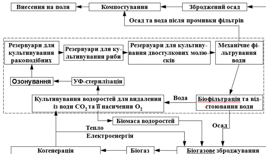
Рис. 3. Блок-схема установки рециркуляційного водопостачання для виробництва продукції аквакультури (ракоподібних, риби і двостулкових молюсків) з культивуванням водоростей для очистки води та виробництвом біогазу
