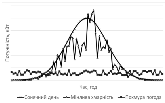
Рис. 2. Типовий добовий профіль виробництва електроенергії від сонячних панелей залежно від погодних умов
