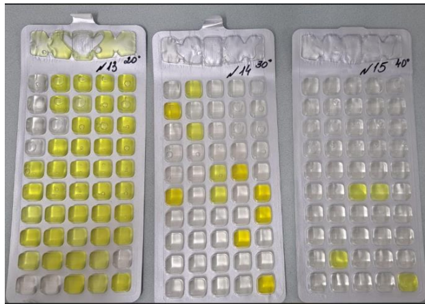
Рис. 1. Дослідження води при різних температурах за допомогою тестових наборів COLILERT-18, ENTEROLERT, PSEUDALERT
