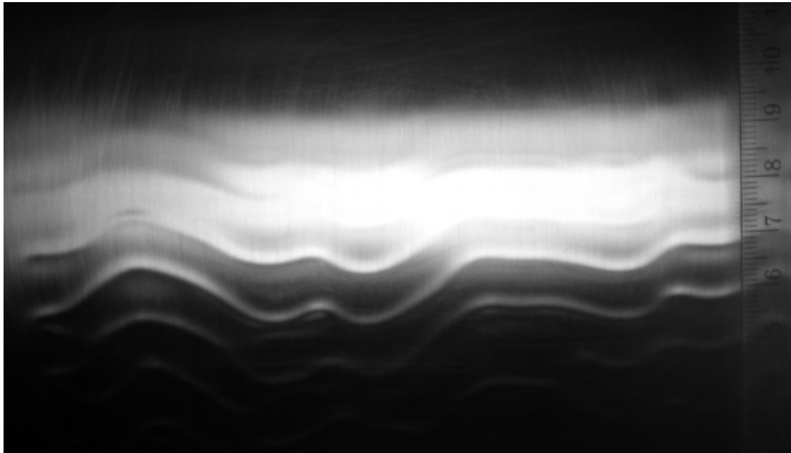
Рис. 4. Зміна режиму течії гравітаційно стікаючої плівки від безхвильового режиму до режиму течії з солітоноподібними тривимірними хвилями.
