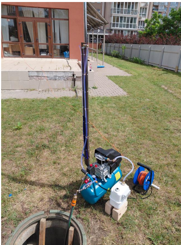
Рис. 3. Фото експериментальної установки із закачування повітря у водоносний горизонт з низьким тиском
