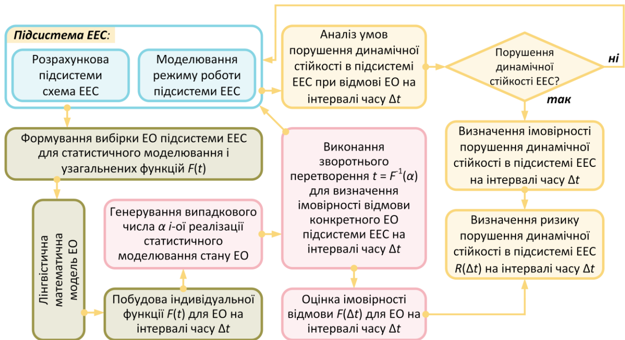
Рис. 3. Структура алгоритму визначення ризику порушення нормального режиму в підсистемі ЕЕС при відмовах ЕО
