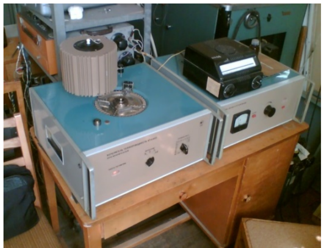
Рис. 3. Вимірювач теплопровідності (ИТ-λ-400)
