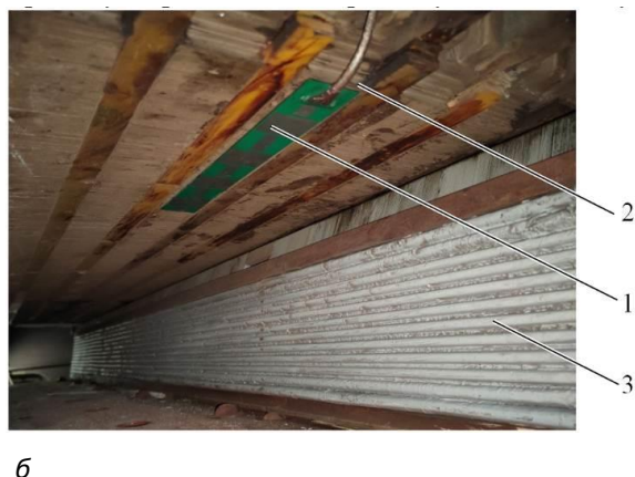
Рис. 1. Схема вимірювання ПП в ГГ ємнісним сенсором
