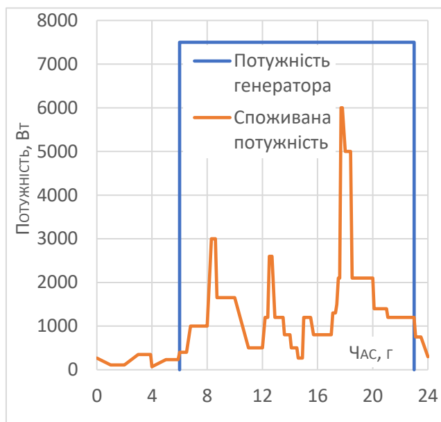
Рис. 2. Система з використанням 7,5 кВА генератора
