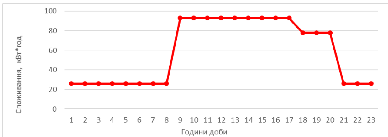
Рис. 2. Графік роботи насосів НС 1, змінений з урахуванням добового ходу сонячної генерації
