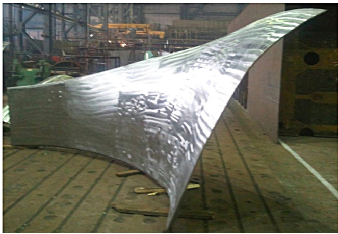
Рис. 2. Фотографія обробленого виливка лопаті турбіни
